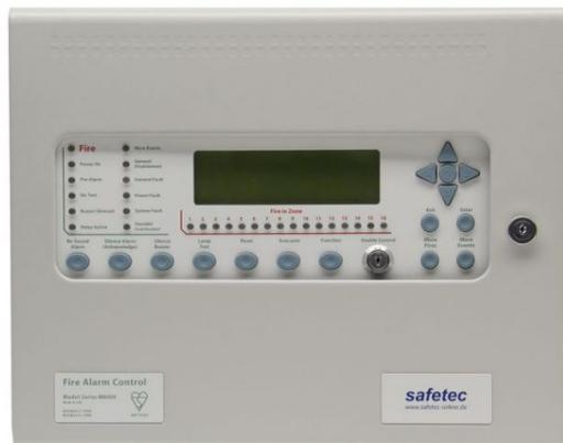
zu 126 Feuermeldern und Alarmgebern. Mehrere Einheiten können über den RS485- Bus zu einem größeren System zusammengeschlossen werden. Standardmäßig beinhaltet die Feuermeldezentrale 8 konfigurierbare potenzialfreie Ein- und Ausgänge, welche durch Zusatzkarten erweitert werden können (Zulassungen in Vorbereitung).
