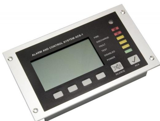
Das ACS-1 ist ein Steuerungssystem für Feuerlöschanlagen. Es kann als ein Steuerungssystem für Löschanlagen mit oder ohne integriertem Feuermeldesystem für eine automatische Löschauslösung genutzt werden. Das externe Feuermeldesystem kann durch ein optionales Interface in dem Anzeigeelement oder dem Fernauslösegerät verbunden werden.
